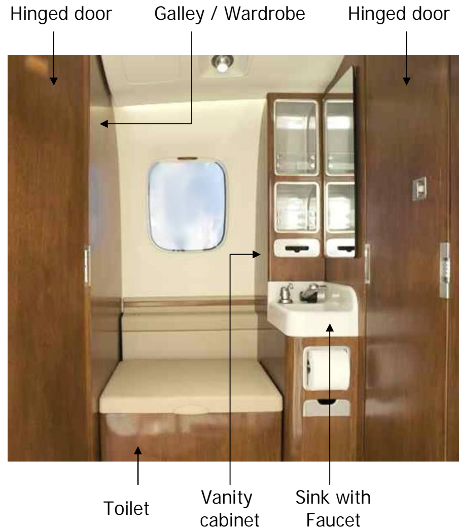
Forward toilet module
